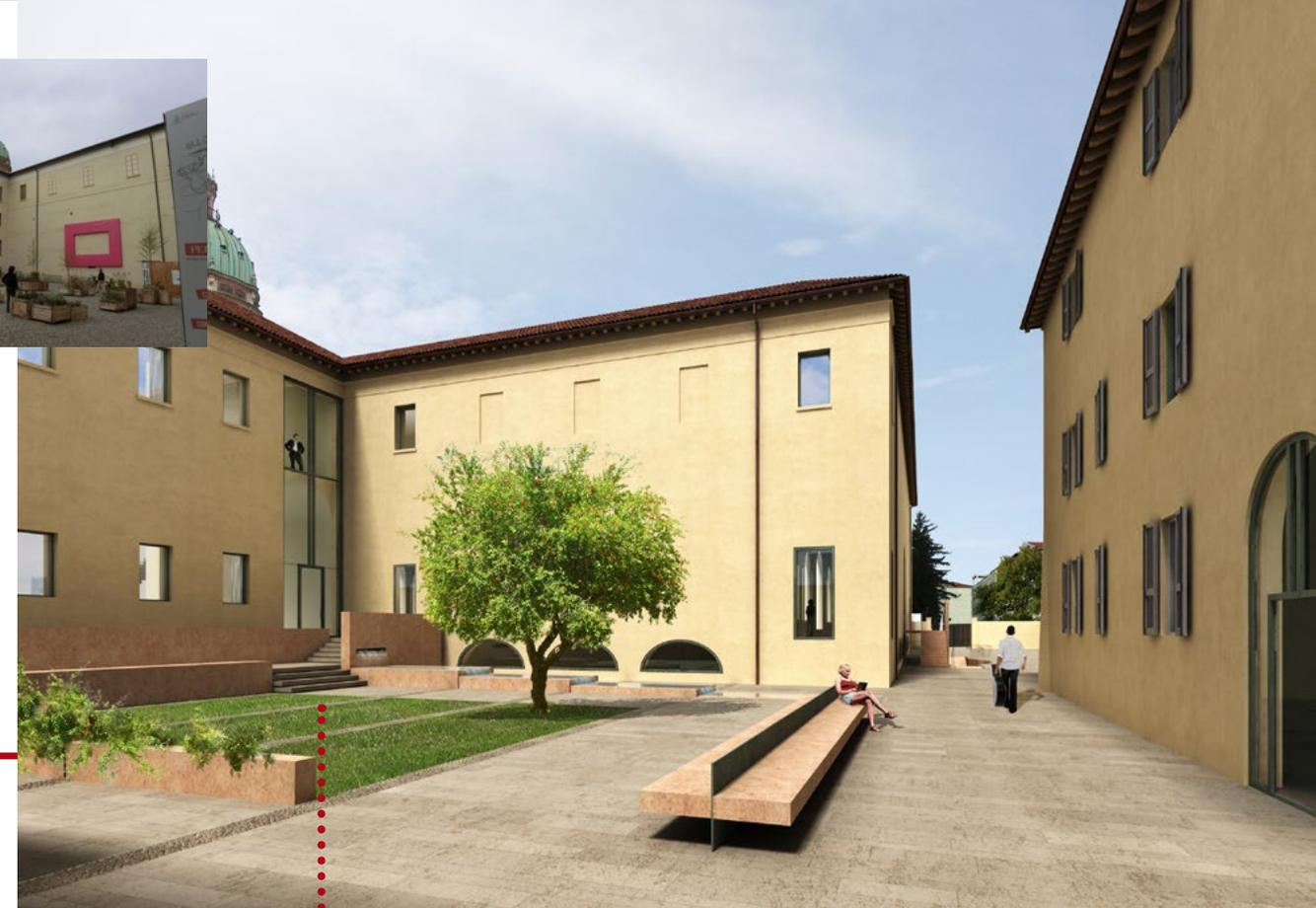
... e proposta di progetto. L'accesso per i diversamente abili si svolge sui lati sud e ovest dell'area cortiliva con due rampe di pendenza inferiore all'8%, interrotte da un pianerottolo intermedio.
